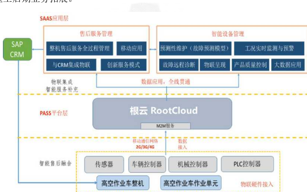
图 2-13 高空作业车产品全生命周期智能服务实施架构
