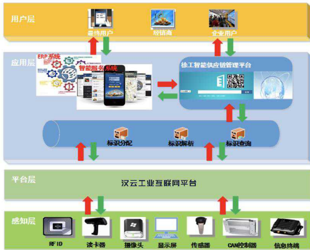
图 2-2 徐工集团智能供应链实施架构
