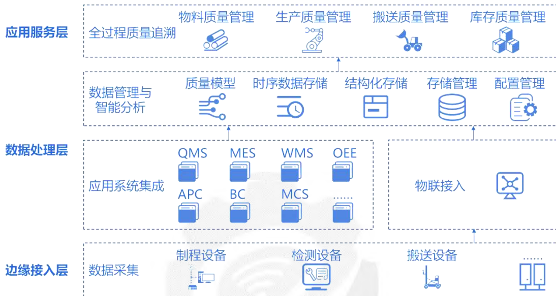
图 3-8 中国电子下属液晶面板企业生产质量追溯案例实施架构
